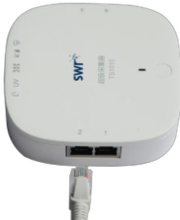
图6 通过传感器连接线与传感器相连
