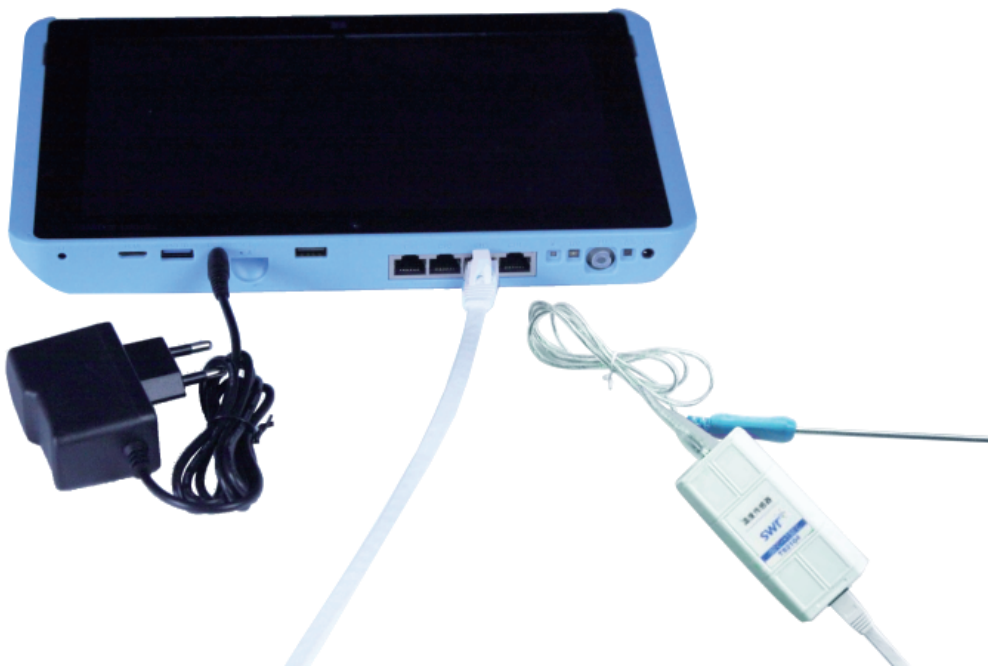
电源线连接、通过网线与传感器连接
