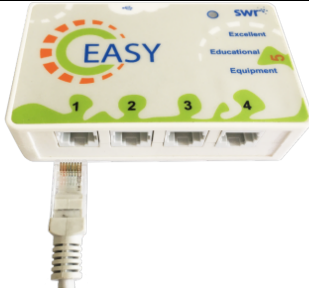
图7：通过传感器连接线与传感器相连
